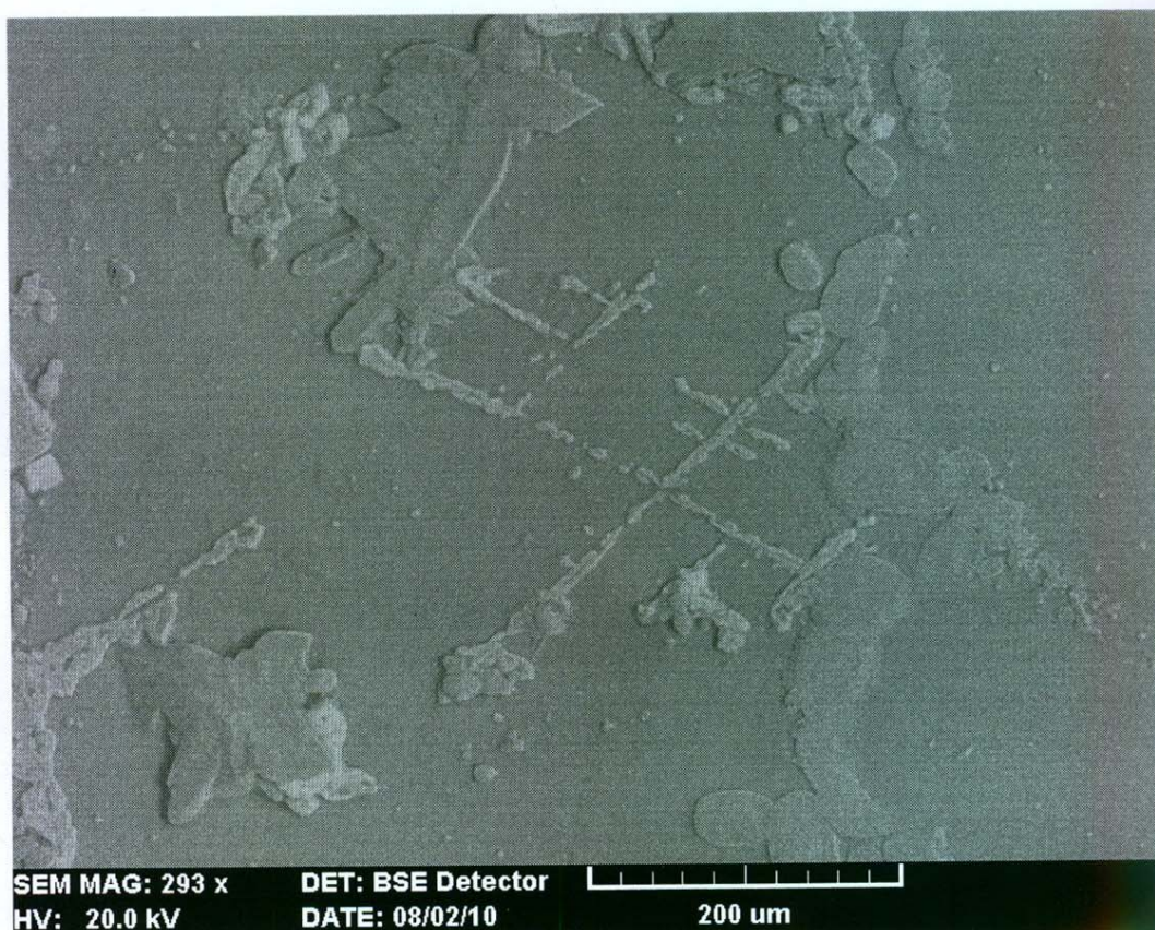
Фото 4. Формы выделений кристаллов в сухом остатке и их химический состав по площади:
